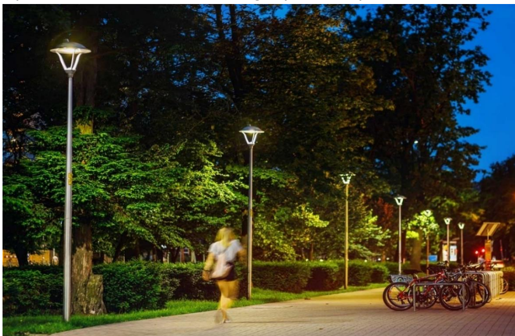
Figura 5.36 – Imagem de referência mostrando a iluminação mais baixa para pedestre e consequentemente iluminando a arborização, espaços para bicicletário incentivando o uso da bicicleta, piso drenante facilitando a microdrenagem pluvial em épocas de chuva intensa.
