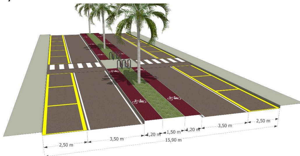
Figura 5.13 - Visão de futuro do trecho da Avenida Brasil na área urbana de Quirinópolis-GO, com a implantação de estacionamentos, canteiros, faixas de pedestre, iluminação pública, ciclovias e arborização.
